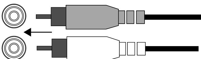
**Se o receiver do veículo não possuir saídas de nível de linha,** conecte as entradas do amplificador Kappa às saídas dos alto-falantes traseiros ou dianteiros usando os adaptadores de fio nu para RCA. (Os crimpes para emenda não vêm incluídos.)
