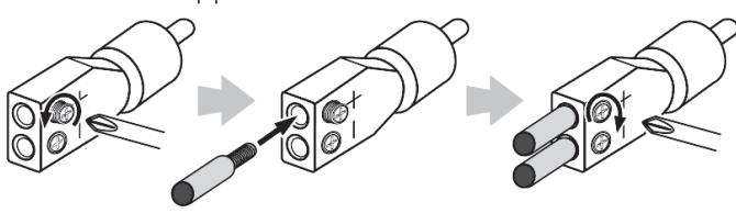
拧松螺丝 插入线缆 拧紧螺丝
