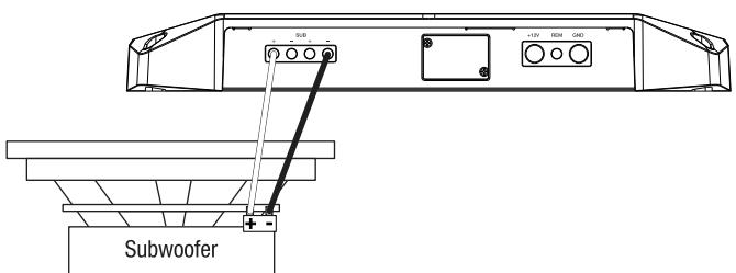
**NOTA:** La impedancia mínima del altavoz para el funcionamiento con subwoofer es de 2 Ohm.
