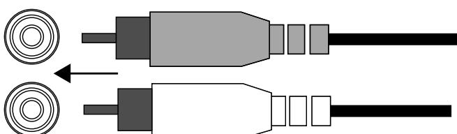
**若汽車音響系統的主機沒有線路電平輸出**，請使用隨附的裸線至 RCA 配接器將 Kappa 放大器的輸入連接至汽車音響系統主機的前或後喇叭輸出(未隨附壓接工具)。
