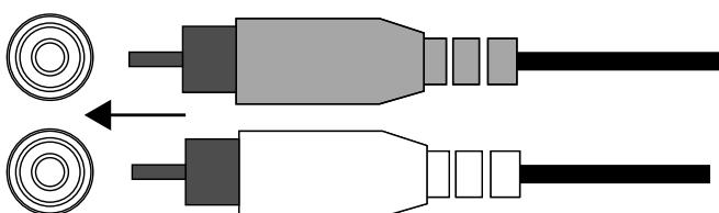
**Si l'unité principale de votre système audio automobile n'a pas de sorties de niveau ligne,** utilisez les adaptateurs de fil dénudé vers RCA fournis pour connecter les entrées de l'amplificateur REF aux sorties de haut-parleurs avant ou arrière de l'appareil principal de votre système audio automobile (cosses pour fils dénudés non incluses).
