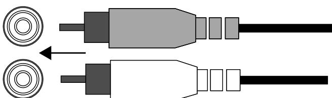
**Si la unidad central del sistema de audio del automóvil no tiene salidas de nivel de línea,** utiliza los adaptadores de cable pelado a RCA suministrados para conectar las entradas del amplificador Kappa a las salidas de altavoz delanteras o traseras de la unidad central de audio del vehículo (no se incluyen los conectores necesarios).
