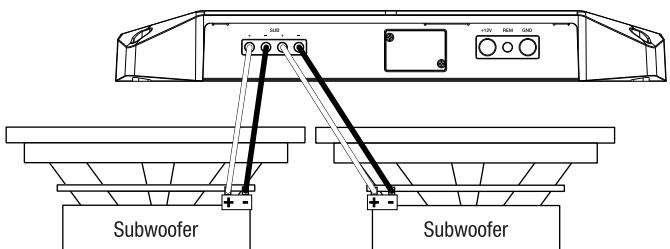
**Para usar um subwoofer,** conecte o fio positivo do subwoofer à saída esquerda + e o fio negativo à saída direita -.
