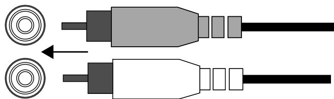
**如果您的汽车音响系统主机没有线路电平输出,**请使用随附的裸线至 RCA 适配器连接 Kappa 功放的输入端和您的汽车音响系统主机的前置或后置扬声器输出端(拼接器不随附)。
